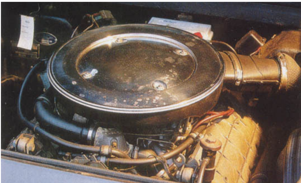
Der aufwendig gebaute Leichtmetall-V6 stammt aus dem Renault 30
